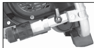
Wasserzufuhr verschlossen (Ventilhebel quer)
