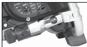
Wasserzufuhr geöffnet (Ventilhebel parallel)
