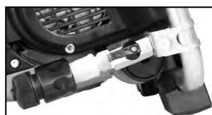
Alimentation d'eau ouverte (levier de vanne parallèle)
