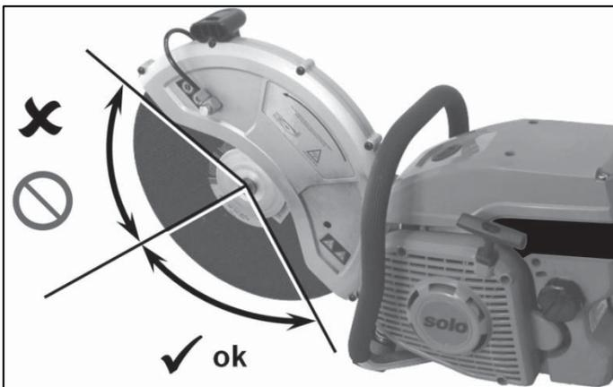
✘ Le secteur supérieur du disque ne doit pas être utilisé pour couper !
