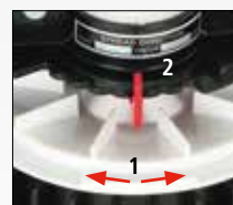
Verstellbare Wurfrichtung (1), Rührwerk (2)
