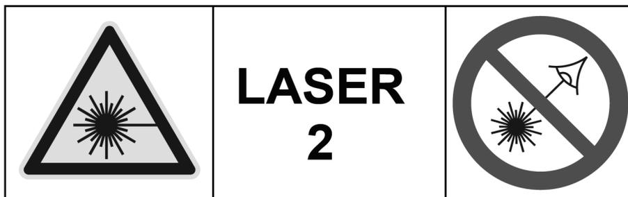
L'appareil est équipé d'un pointeur laser. Les rayons laser peuvent causer des lésions oculaires. Un rayon laser incontrôlé dans la pièce peut irriter ou mettre des personnes en danger en dehors de l'aire de travail.
