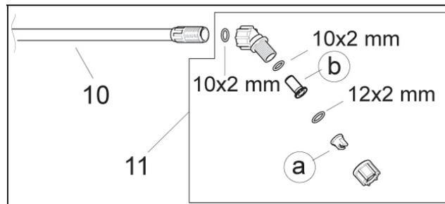
Serrer la tête du gicleur (11) avec le joint circulaire (10x2 mm) à la main à la lance d'aspersion. Ne pas utiliser d'outil !
