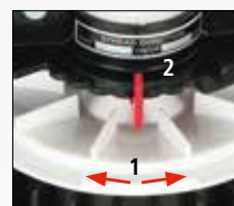
Dirección regulable de lanzamiento (1), mezclador (2)
