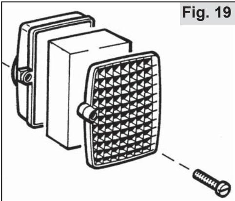
Avant d'ouvrir le filtre à air, fermer le volet de démarrage pour éviter que des impuretés n'entrent dans le carburateur.
