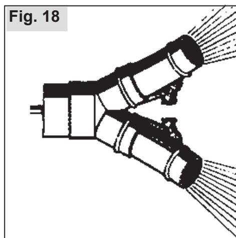
Retirer la buse standard (15) du tube pulvérisateur, faire glisser la double buse sur le tube pulvérisateur.
