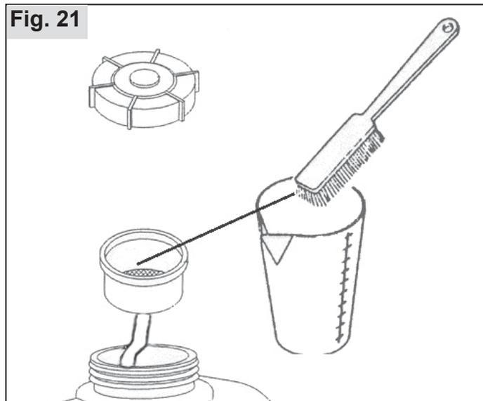
Nettoyez, de temps à autre, l'entonnoir-filtre dans l'orifice du réservoir, le filtre pour les jeux d'accessoires et toutes les pièces en contact avec le produit à pulvériser, avec de l'eau et une brosse souple.
