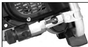
Wasserzufuhr geöffnet (Ventilhebel parallel)
