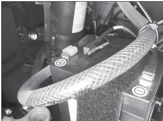
**Pôle plus :** Tirez le capuchon de sécurité de la connexion du pôle positif de la batterie et branchez fermement la fiche du câble positif sur la connexion de la batterie.
