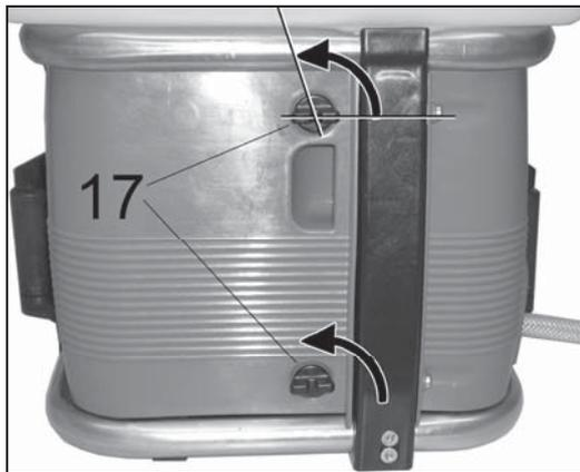
Mettre les deux clapets de fermeture (17) du carter de protection en position ouverte en les tournant d'env. 100° dans le sens contraire des aiguilles d'une montre, ouvrir le carter de protection.
