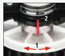
Verstellbare Wurfrichtung (1), Rührwerk (2)
